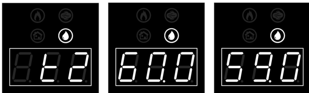
Рисунок 3 — Настройка границ температуры теплоносителя
