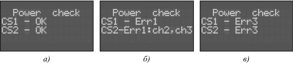
Рисунок 14.7 – Возможные варианты отчётов о втором этапе диагностики в одноблочных котлах, выполненных по схеме треугольник: а – все каналы исправны; б – в каналах 1, 2 и 3 отсутствует ток; в – залипание реле 1 проверяемого ДТ1 (т.к. в данной схеме ДТ1 проверяет только канал 1) и залипание одного или нескольких реле проверяемых ДТ2
