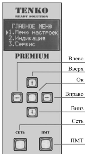
Рисунок 14.1 – Передняя панель котла
