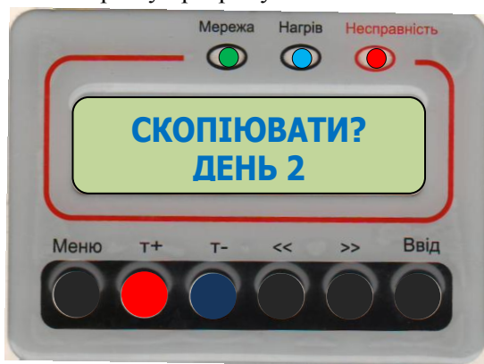
Рис. 24 Вид панелі управління при копіювання програми «ДЕНЬ 2»
