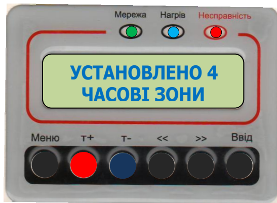
Рис. 21 Вид панелі управління при індикації повідомлення про успішну установку потрібної кількості часових зон
