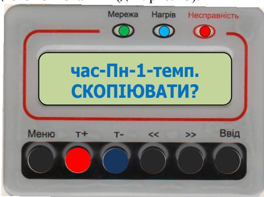
Рис. 23 Вид панелі управління при виборі функції копіювання
