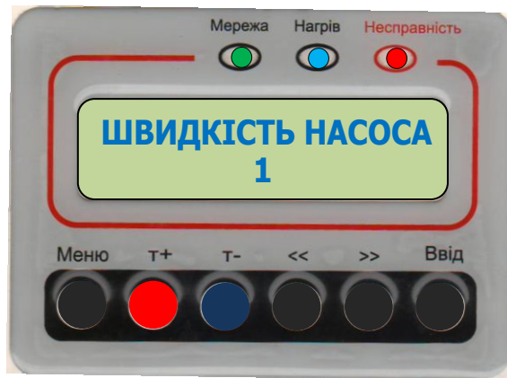
Рис. 14 Вид панелі управління при установці швидкості насоса
