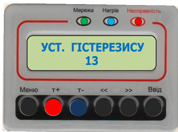
Рис. 11 Вид панелі управління при установці температурного гістерезису
