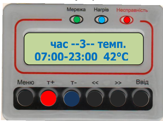
Рис. 19 Вид панелі управління при установці третього часового інтервалу
