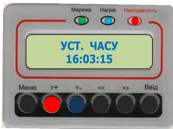
Рис. 15 Вид панелі управління при установці часу
