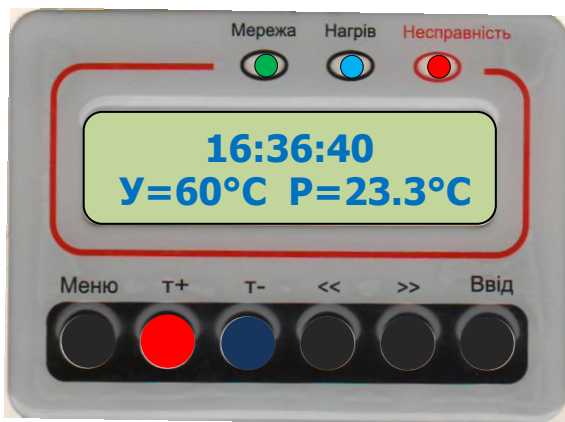
Рис. 9 Вид панелі управління при установці температури нагріву теплоносія (води) першим способом
