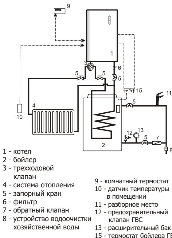
Регулирование происходит при помощи бесштепенчатого сигнала ON/OFF, подведенного к клеммам блока ГВС. При поступлении требования на нагрев ГВС (ON) происходит регулирование температуры нагрева ОВ на установленную величину 80°C. После нагрева хозяйственной воды котел автоматически возвратится в исходный рабочий режим. Ввод котла в режим ГВС происходит автоматически при требовании на нагрев хозяйственной воды (пользователь этот режим самостоятельно установить не может).
