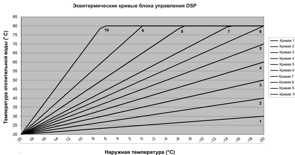
Последовательность действий при выборе эквивермической кривой указана в пункте "Установка параметров". При уменьшении номера эквивермической кривой параметром Р8 меньше "1", на дисплее будет отображен текст "NE", произойдет аннулирование эквивермического регулирования.
