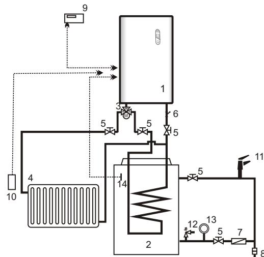
Котел будет поддерживать установленную температуру воды в бойлере с гистерезисом, устанавливаемым при помощи параметра Р21, диапазон от 1 до 10°C (этот параметр может устанавливать только сервисный техник).
