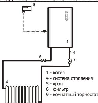
При требовании на нагрев ОВ (комнатный термостат соединен) регулирование температуры ОВ происходит таким же образом, как без подключения комнатного термостата до тех пор, пока требование на нагрев ОВ не окончается (комнатный термостат разъединен).
