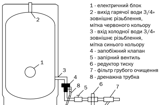
Рис.4. Схема підключення ЕВАД Steatite підлогових.
