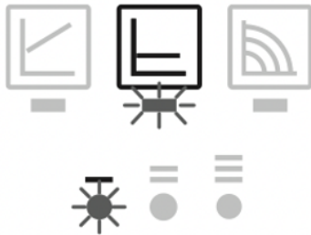
Рис. 10 Активация заводской установки
