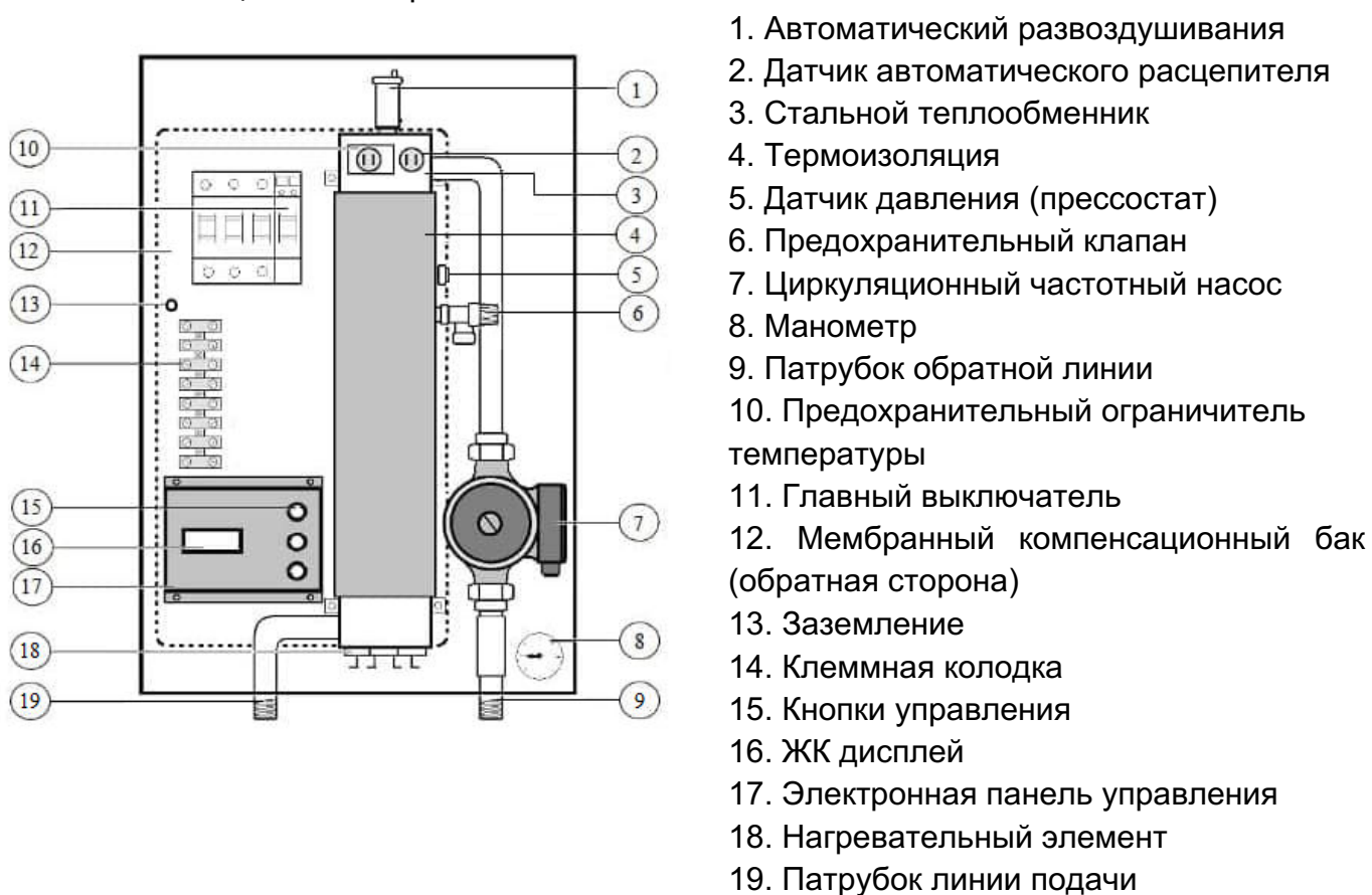
Рис. 1 Функциональные элементы котла AVL Joule AJX-SPT eco
