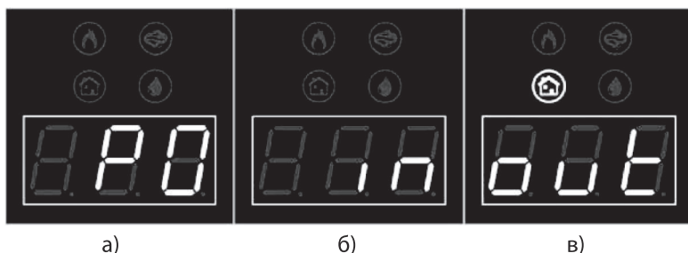
Малюнок 4 - Вибір режиму роботи котла
