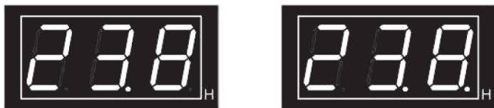
Малюнок 2. Основний режим роботи і режим установки температури: а - нагрів виключений, б - нагрів включений
