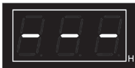
Малюнок 4. Показання індикатора при несправності або відсутності датчика температури.
