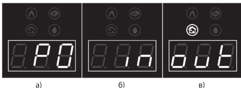
Малюнок 4 - Вибір режиму роботи котла
