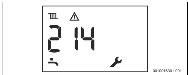
Мал. 6 Приклад коду несправності
