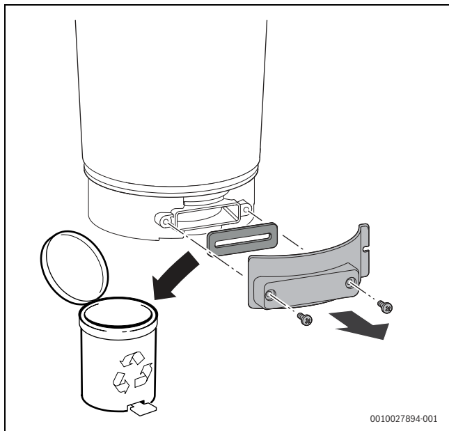
Мал. 60 Відкриття контрольно-ревізійного отвору
