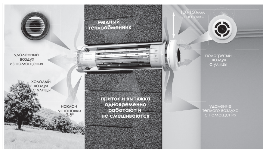
Рис.1. Принцип работы рекуператора PRANA-150, PRANA-200C, PRANA-200G
