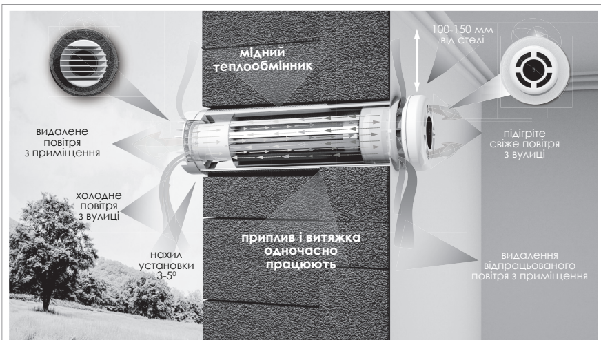
Рис.1. Принцип роботи рекуператора PRANA-150, PRANA-200C, PRANA-200G
