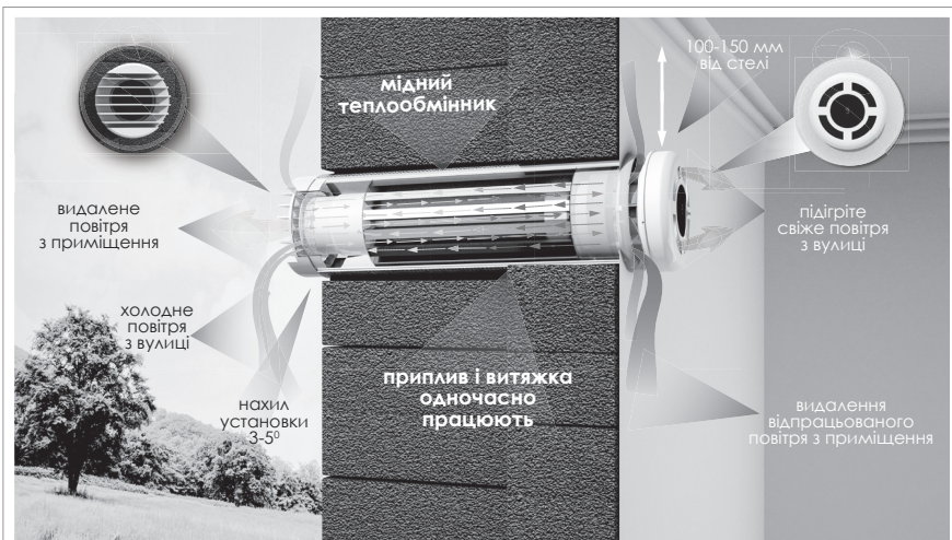
Рис.1. Принцип роботи рекуператора PRANA-150, PRANA-200C, PRANA-200G
