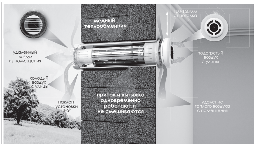
Рис.1. Принцип работы рекуператора PRANA-150, PRANA-200C, PRANA-200G
